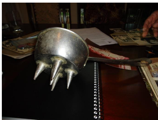
Figura 37 - Bico de metal preparador de fios de ovos idealizado por D. Antonia Lunardelli Ramalho como ferramenta de trabalho. Foto tirada por mim durante a pesquisa de campo e utilizada com permissão.
